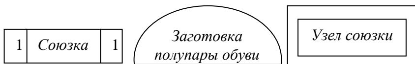
Рис. 2. Условные обозначения детали, узла, заготовки верха обуви в схеме сборки заготовки верха
